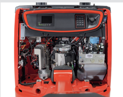
Accès facile et rapide aux principaux composants grâce au panneau de service avant
