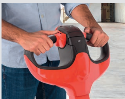
Poignée ergonomique du timon avec commande intégrée de traction et de levée
