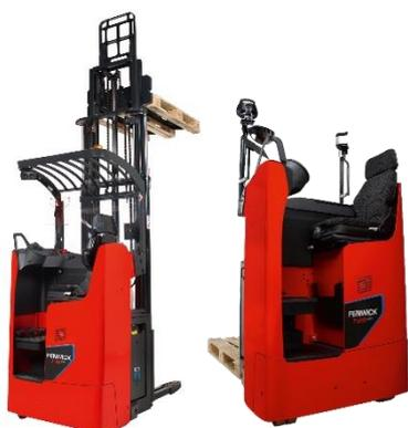
Après avoir lancé les versions à conducteur porté DEBOUT (S ou SF) puis ASSIS COMPACT (R) avec un châssis de 820 mm seulement, Fenwick, numéro 1 de la manutention et fournisseur de solutions et de services pour l'intralogistique, finalise sa gamme avec la version ASSISE CONFORT (RW) via un châssis de 970 mm.
