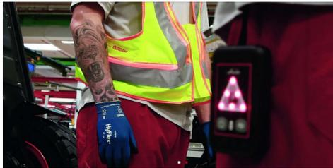
Afin de répondre aux nouvelles règles de distanciation sans perturber les processus de travail des différents intervenants dans les entrepôts, Fenwick-Linde propose 2 solutions : une fonction de distanciation intégrée à sa veste de sécurité interactive Fenwick Safety Guard ou des « modules piétons » autonomes.
