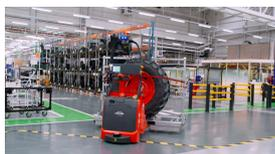
Le site du fabricant de machines agricoles exploite une solution automatisée Fenwick pour l'approvisionnement des roues de tracteurs en bord de ligne de montage. C'est l'un des points clés de son projet d'usine 4.0.
