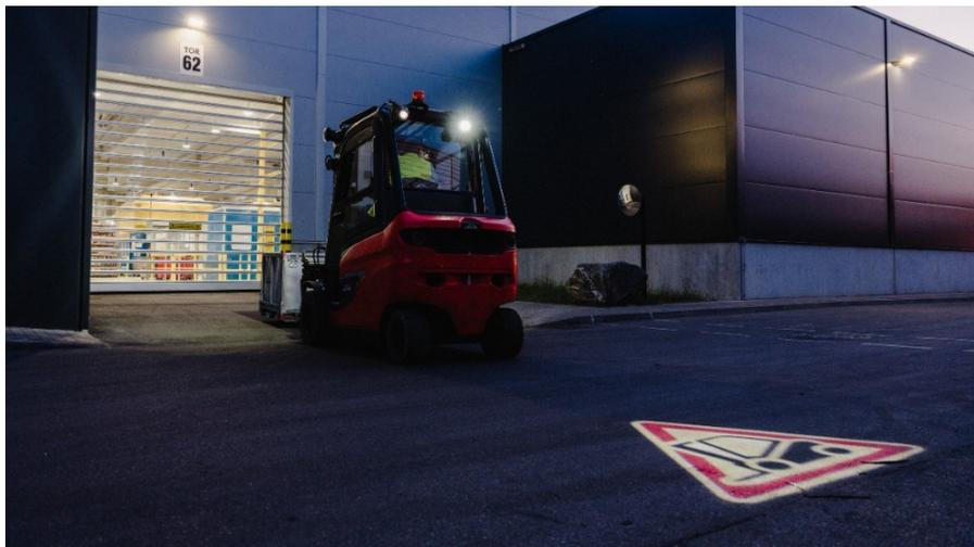
**Partout où des portes à ouverture rapide sont installées dans les centres de production et/ou de logistique, les utilisateurs de chariots pourront bénéficier du nouveau module "contrôle de porte" proposé dans le cadre du système d'assistance innovant Safety Guard de Fenwick-Linde. Ce système de contrôle intelligent permet la communication entre les chariots de manutention et les infrastructures, afin d'éliminer les coûts élevés dus aux dommages causés par les collisions.**
